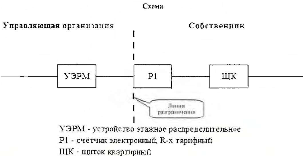
Исполнитель несет ответственность за надлежащее состояние и работоспособность питающих электрических сетей на квартиру согласно нижеуказанной схеме до прибора учета (мультипликаторной линии слева).
